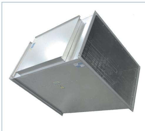
Корпус нагревателя выполнен из оцинкованного стального листа, нагревательные элементы изготовлены из нержавеющей стали. Во внутренней электропроводке и креплении элементов конструкции используется медь и латунь. Все материалы тщательно подобраны, проверены и обеспечивают безопасность и долговечность работы. Класс защиты нагревателей - IP40.
