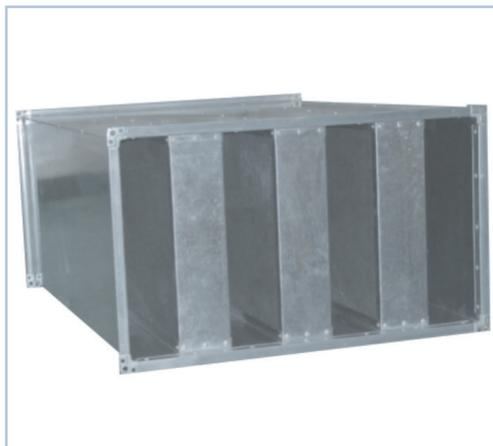
Пластинчатый шумоглушитель представляет собой коробку из тонкого металлического листа, проходное сечение которой разделено пластинами, облицованными звукопоглощающим материалом, в качестве которого используется кашированная минераловатная плита.
