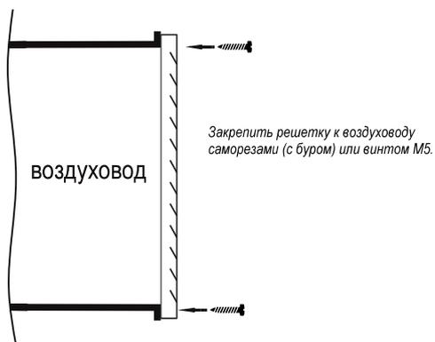
**3** Крепление решетки к клапану стенового исполнения.
