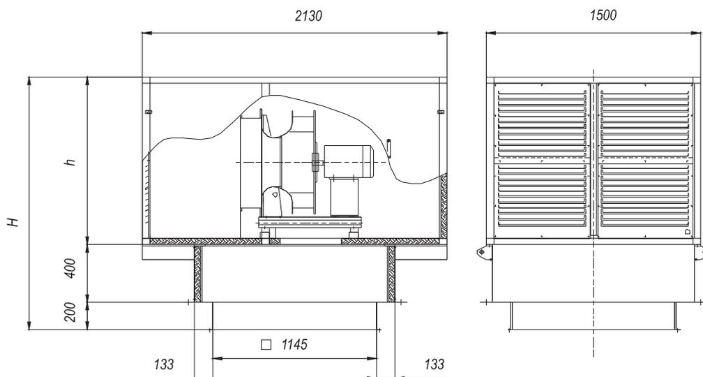
**Технические характеристики вентиляторов ВКП-Р со свободным колесом**
