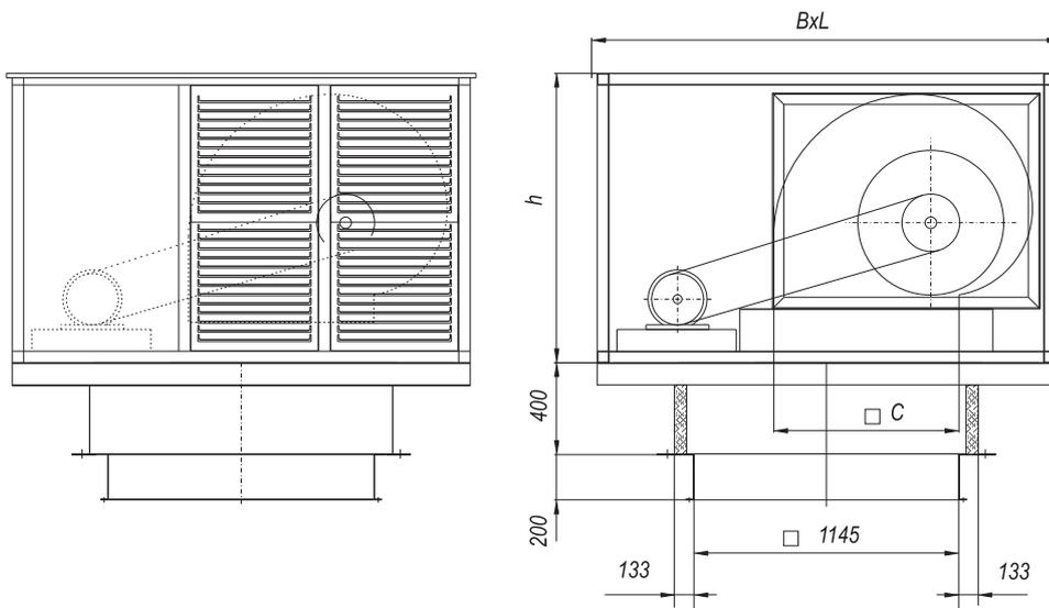
Технические характеристики вентиляторов ВКП-Р (радиальный вентилятор двухстороннего всасывания)
