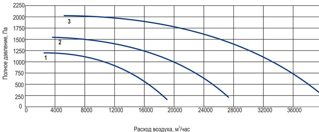
ВЕНТИЛЯТОР ВКП-Р (РАДИАЛЬНЫЙ ВЕНТИЛЯТОР ДВУХСТОРОННЕГО ВСАСЫВАНИЯ)
